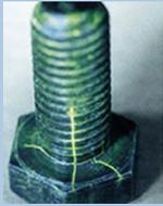
Figura 1 Detección de grietas en un tornillo utilizando líquidos penetrantes.
